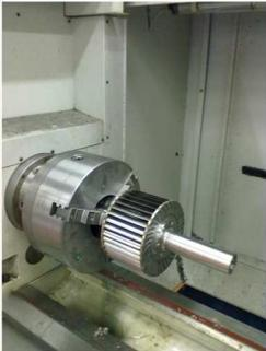
La girante del prototipo di turbina realizzata nei laboratori dell'OAPa
